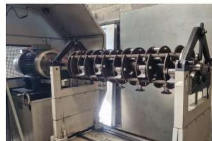
Rotor installé sur le banc d'équilibrage
